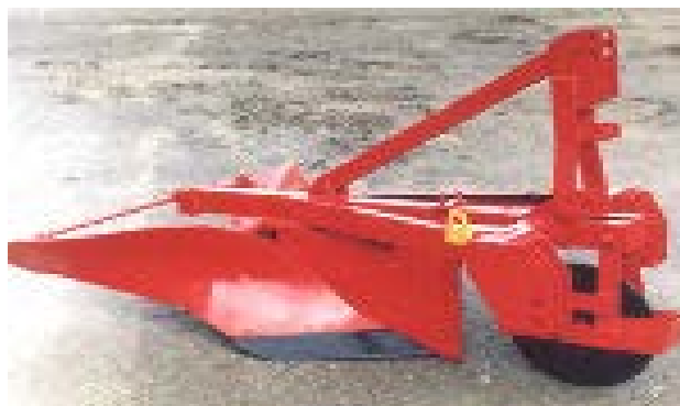
Рис. 3.8. Плуг комбинированный лесной ПКЛ-70 с черенковым и дисковым ножом: 1 - рама; 2 — навесное устройство; 3 - черенковый нож; 4 - корпус плуга; 5 - опорная пята; 6 - лемех
