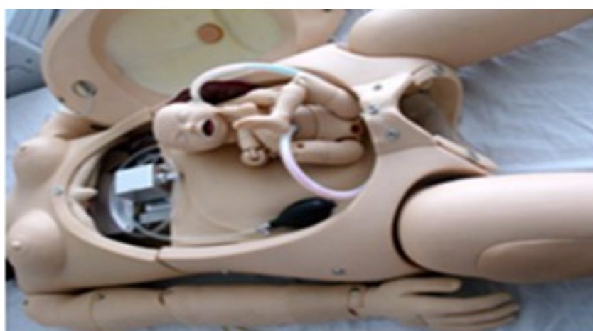
Рис. 1. GD/F56 – роботизированный манекен-симулятор роженицы: а) вид сверху; б) вид изнутри без плода – изгоняющий механизм; в) с плодом при головном предлежании; г) с плодом при тазовом предлежании.
