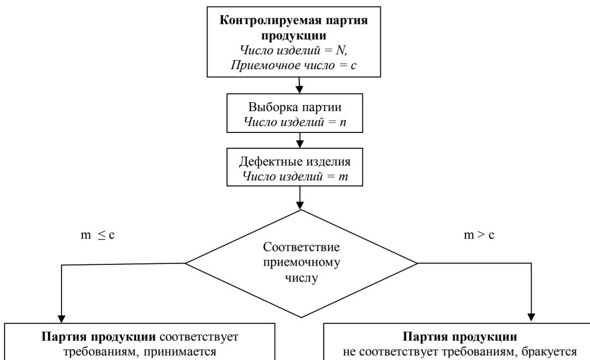
Рис. 5. Схема одноступенчатого плана выборочного контроля по альтернативному признаку
