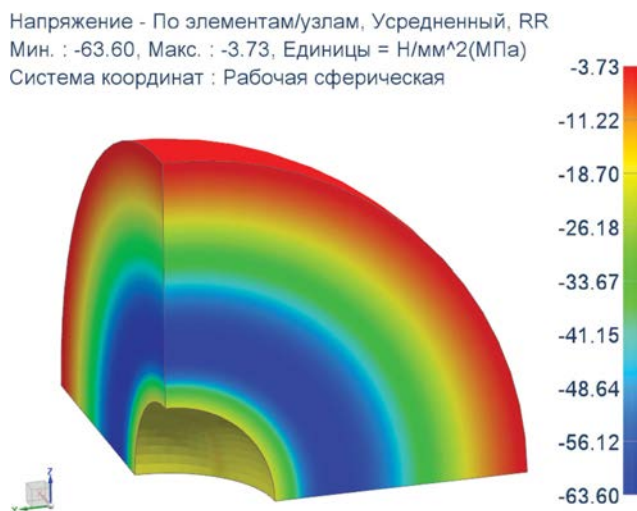
Рисунок 1.31. Результаты решения задачи термоупругости, поле распределений радиальных напряжений, МПа
