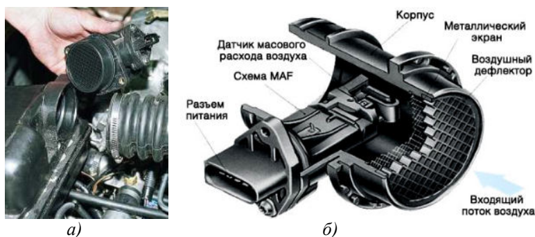
Рис. 35 – Датчик массового расхода воздуха: а - место установки; б - устройство
