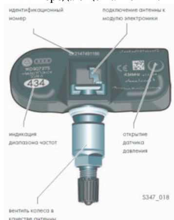
Рис. 236 - Модуль электроники колеса в RDK без указания неисправного колеса:
