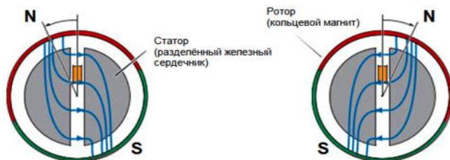
Рис. 118 - Принцип работы датчика дорожного просвета
