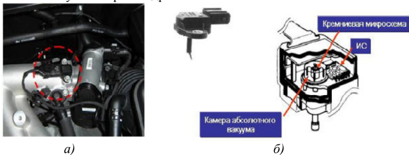
Рис. 39 - Датчик давления в коллекторе: а - место установки; б - устройство
