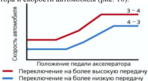
Рис. 10 - Характеристические линии переключения между 3-й и 4-й передачами
