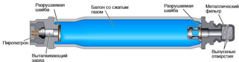
Рис. 151 - Гибридный газогенератор с газом под давлением
