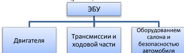
Рис. 2 - Классификация ЭБУ по функциональному назначению
