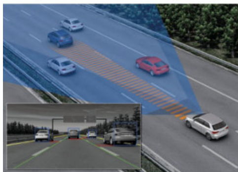
Рис. 187 - Схема работы полуавтоматического круиз-контроля
