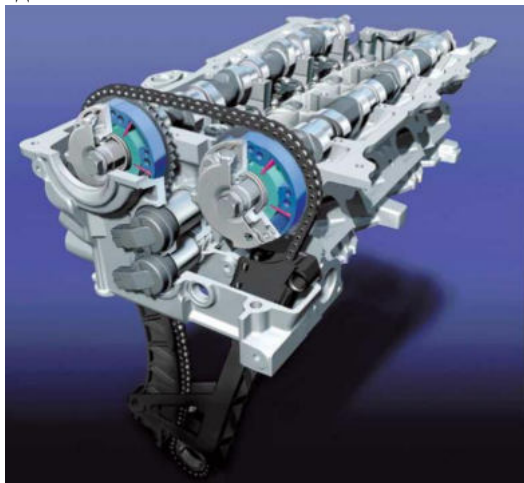
Рис. 56 - Общий вид системы непрерывного изменения фаз газораспределения с использованием лопастного гидравлического двигателя
