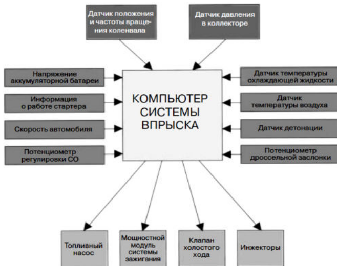
Рис. 25 - Структура системы электронного управления бензиновым двигателем
