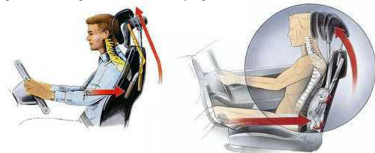
Рис. 154 – Срабатывание активных подголовников с механически приводом
