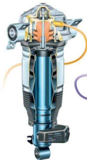
Рис. 11301 - Амортизатор с регулировкой воздушного подпора
