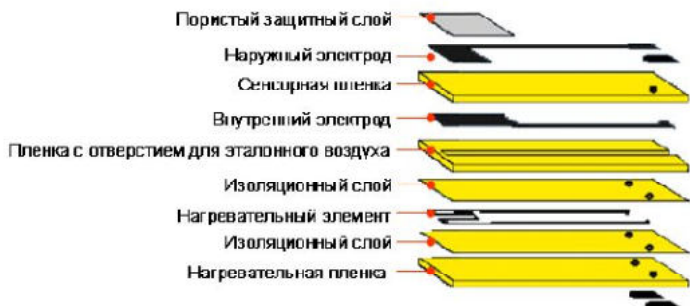
Рис. 23 - Структура чувствительного элемента датчика кислорода
