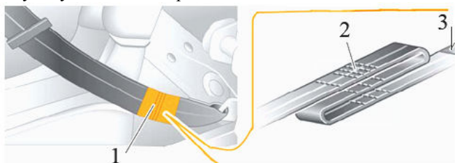
Рис. 161 - Петлеобразный прошитый ремень безопасности: 1 – прошитая зона ремня безопасности; 2 – швы; 3 – зажим ремня
