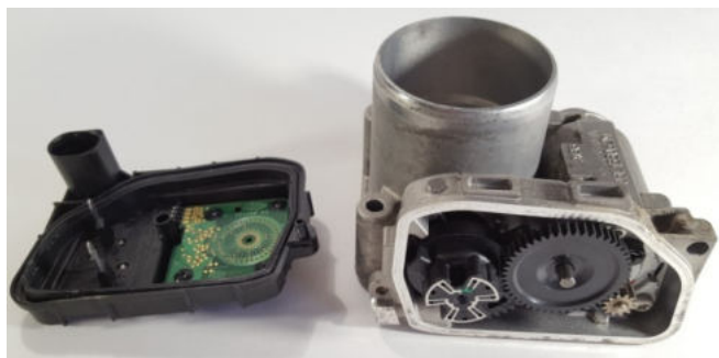
Рис. 130 - Вид и устройство модуля управления дроссельной заслонки
