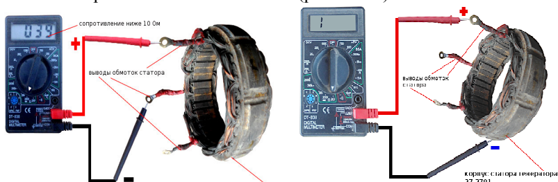
Рис. 193 - Схема проверки обмотки статора:
