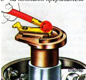
Рис. 203 - Проверка изоляции ротора распределителя
