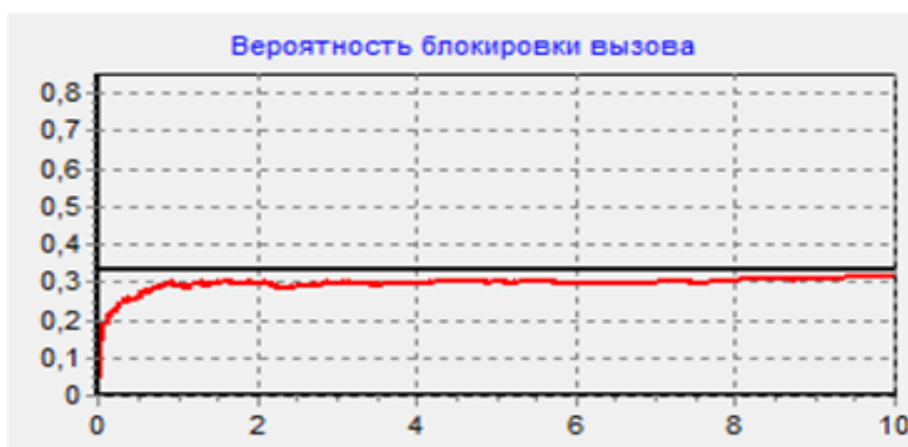
Рис.3. График вероятности блокировки вызова с параметрами: T = 10, N = 50, \Delta = 0,001, \lambda_1 = 5, \lambda_2 = 20, \mu_1 = 10, \mu_2 = 10, n = 3, n_1 = 1.
