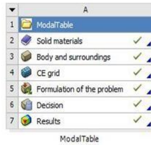
Рисунок 2.5. Модуль расчета, хранения и передачи частот свободных колебаний каждой лопасти винта.
