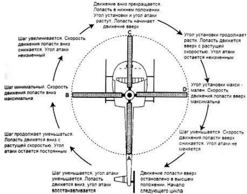
Рисунок 1.19. Изменение углов установки, атаки и взмаха лопасти при управлении циклическим шагом
