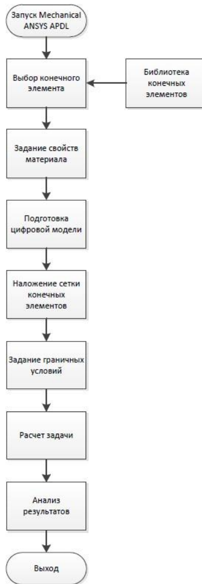
Рисунок 3.1 – Блок-схема решения задачи в программном комплексе Mechanical ANSYS APDL
