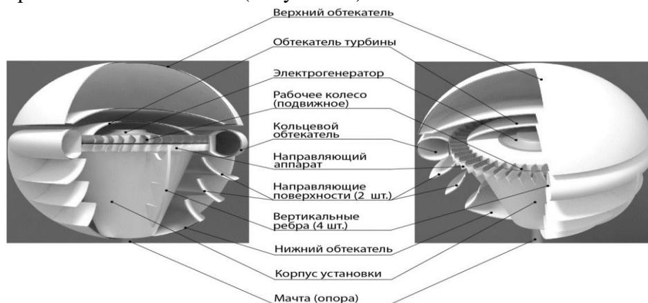
Рисунок 12 – Внутреннее устройство ветро-солнечной установки
