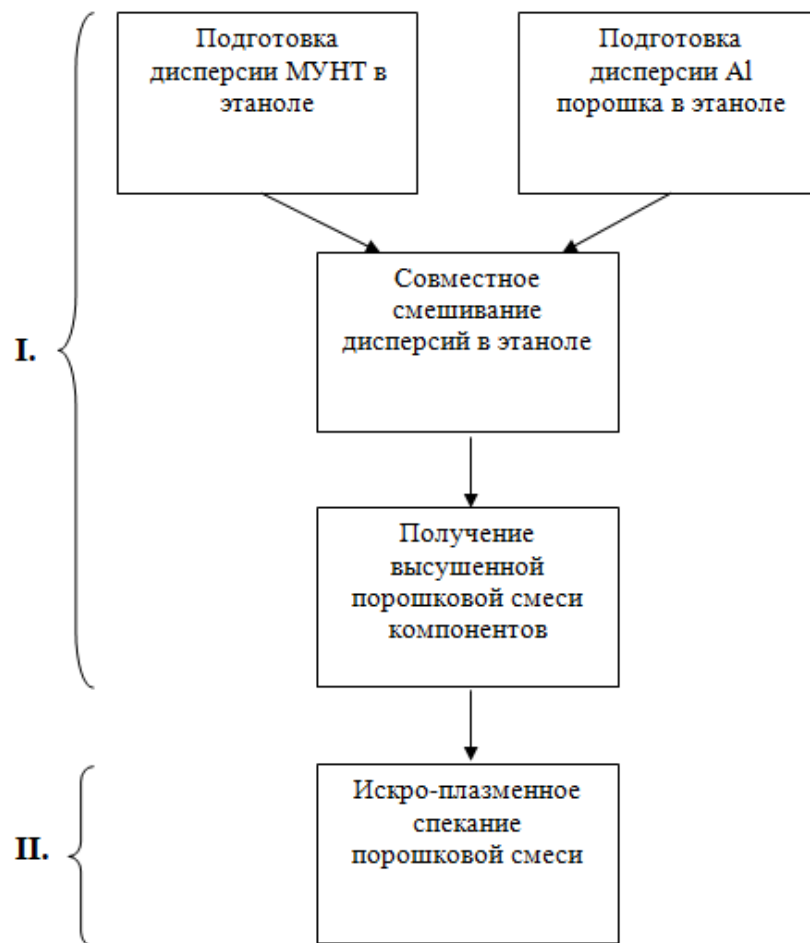
Рисунок 27 – Схема лабораторной технологии получения композитов
