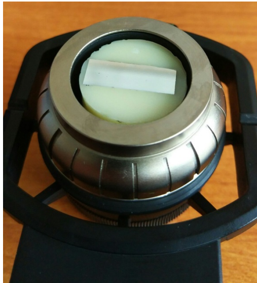
Рисунок 32 – Общий вид образца в держателе для исследования на СЭМ
