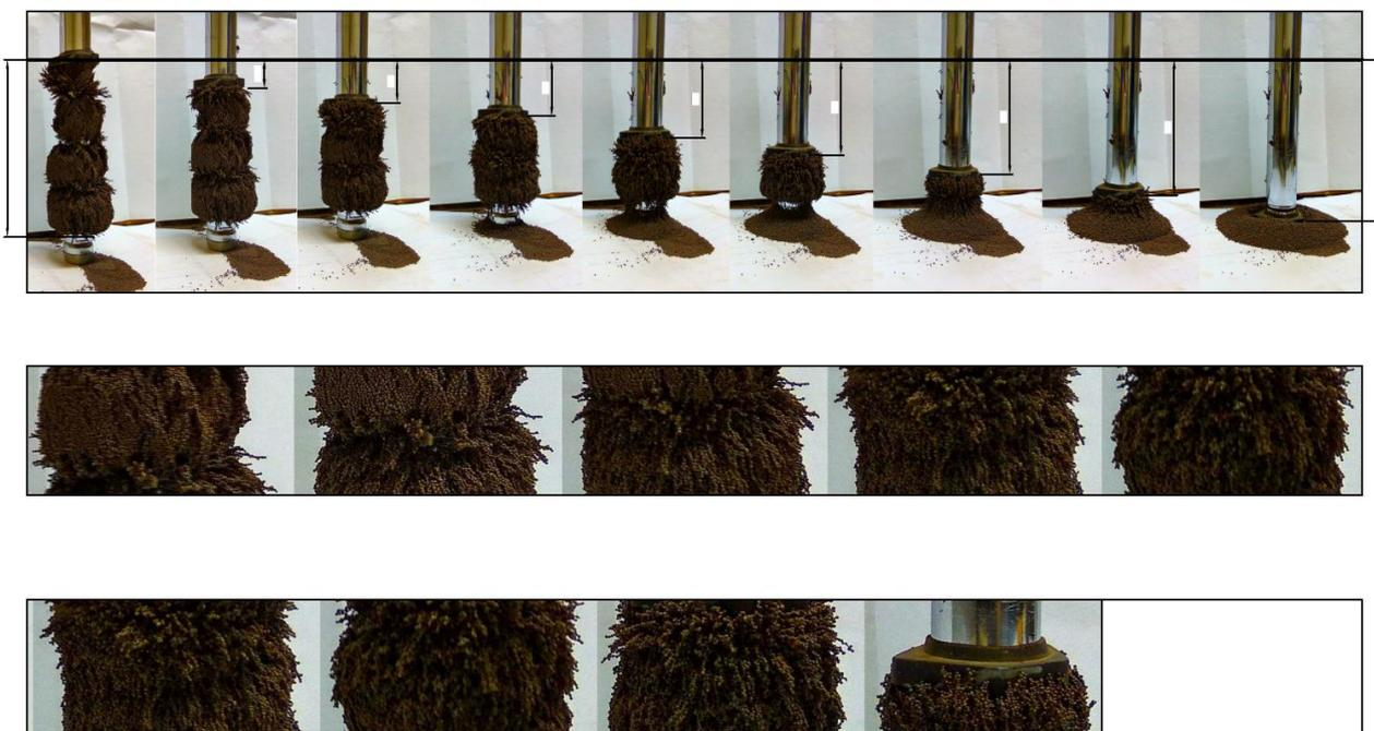
Рис. 3.23. Форма и структура осадка при его удалении на поверхности патронов магнитной системы
