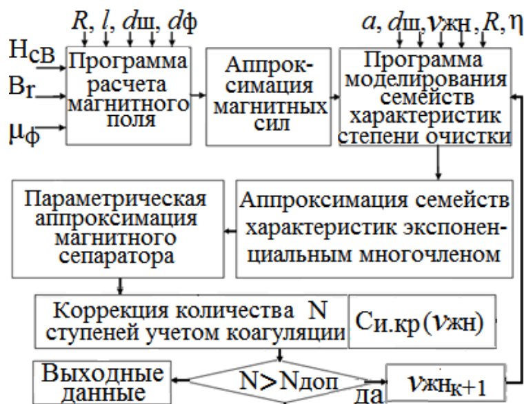
Рис. 6.1. Алгоритм расчета магнитного сепаратора
