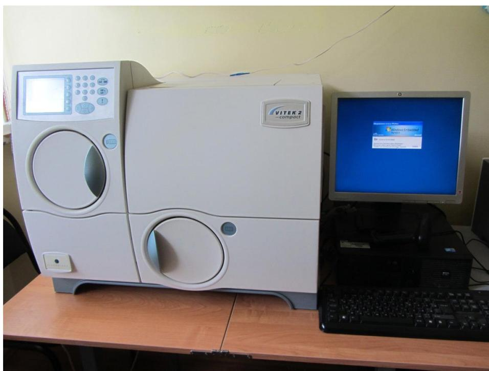
Рисунок 12 - Бактериологический анализатор Vitek-2 compact
