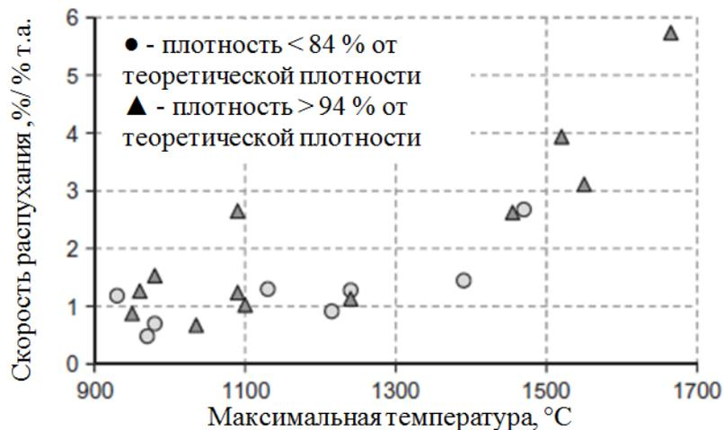
Рисунок 1.8 – Скорость распухания нитридного топлива [37]
