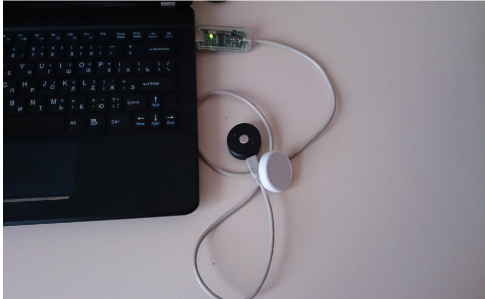
Рисунок 3. Программно-аппаратный комплекс для мониторинга температуры поверхности КМТП-МИДА (совместная разработка ЗАО «МИДАУС» и «Ульяновского государственного университета»)
