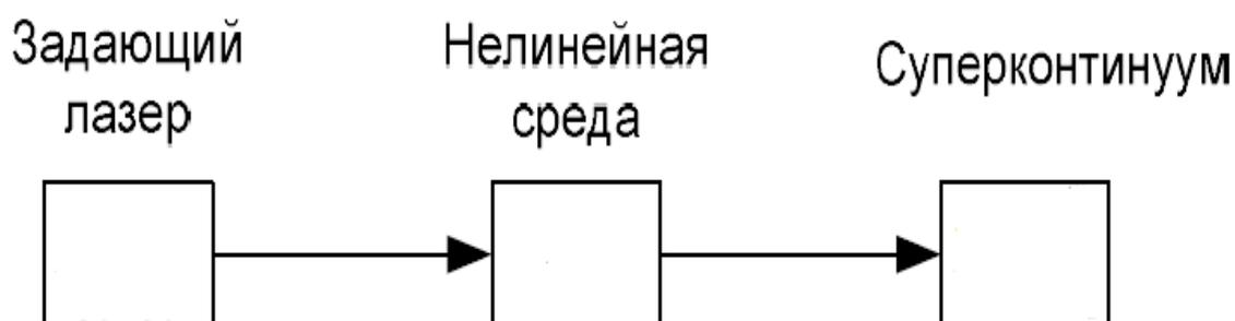
Рис. 42. Одностадийная схема генерации СК.
