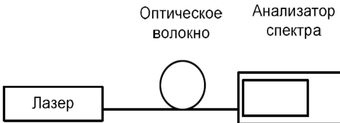
Рис. 43. Схема регистрации выходного излучения.
