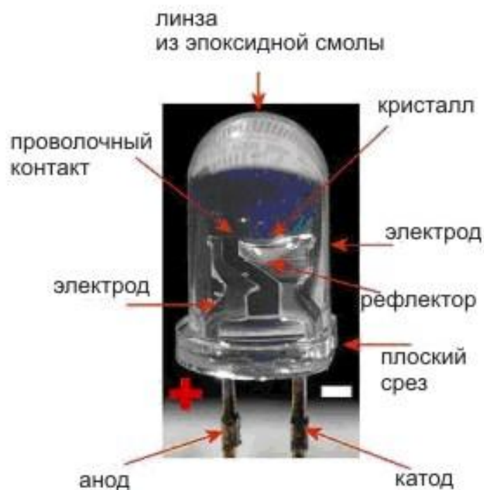
Рис. 3. Конструкция светодиода
