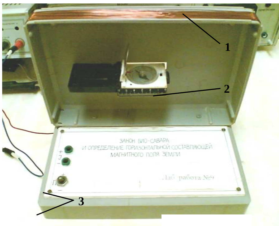
Рис. 16.6. Установка для определения горизонтальной составляющей магнитного поля Земли
