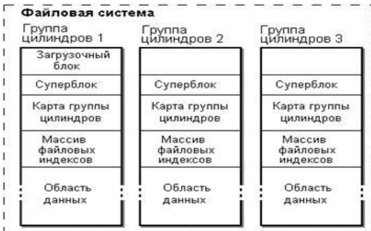
Рис. 34. Раздел с UFS: вторичный загрузчик (загрузочный блок) есть только в первой группе цилиндров
