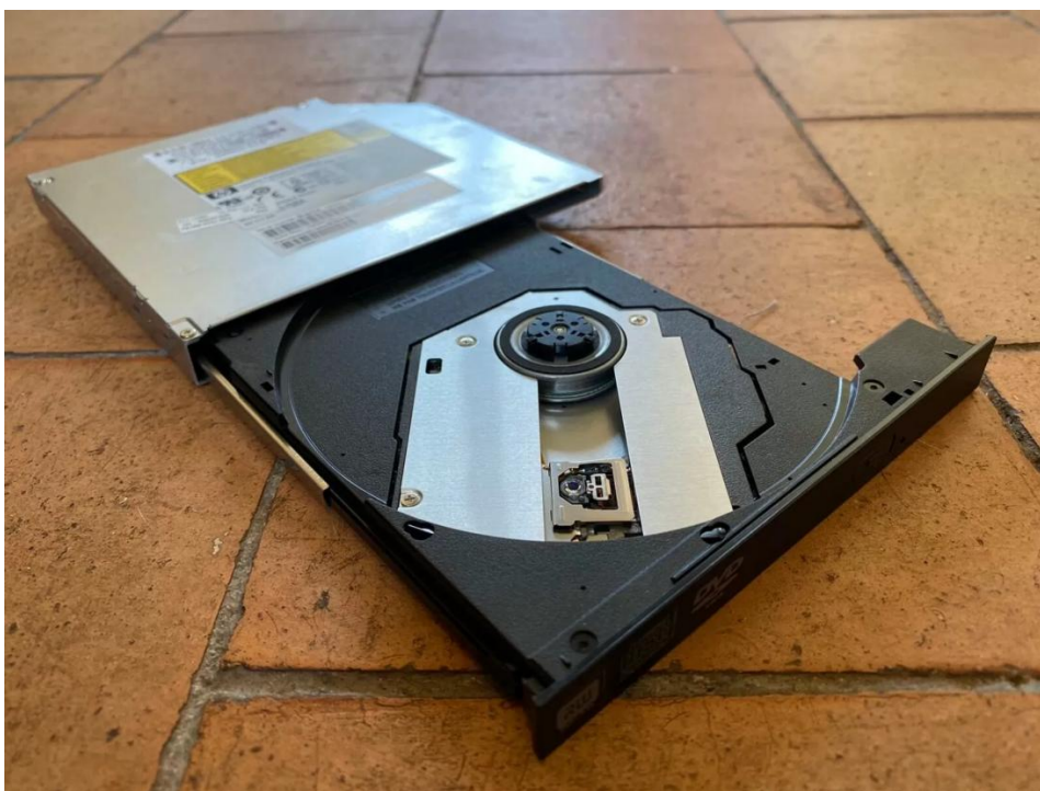
Рис. 16. DVDROM от ноутбука. Видны шпиндельный двигатель в центре и лазерная головка ниже
