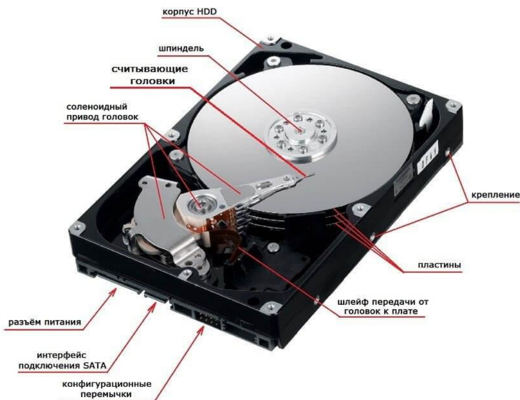
Рис. 2. Устройство винчестера
