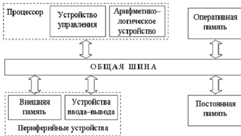
Рис. 3. Архитектура фон Неймана в более современном представлении
