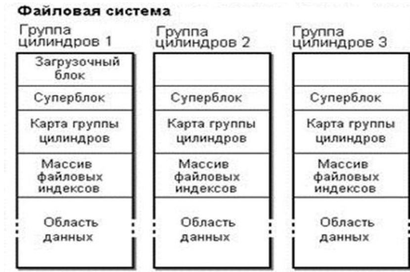
Рис. 29. Раздел с ufs: вторичный загрузчик есть только в первой группе цилиндров
