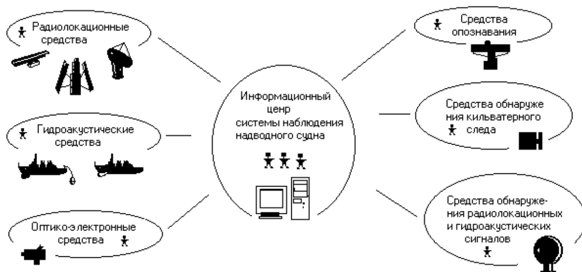
Рис. 1. Состав системы наблюдения надводного судна
