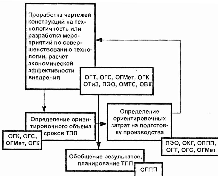
Рис. 7. Схема функций предварительной проработки документации технологической подготовки производства: ОГТ – отдел главного технолога; ОГС – отдел главного сварщика; ОГМет – отдел главного металлурга; ОГК – отдел главного конструктора; ОППП – отдел планирования и подготовки производства; ОТиЗ – отдел организации труда и зарплаты; ПЭО – планово-экономический отдел; ОМТС – отдел материально-технического снабжения; ОВК – отдел внешней кооперации
